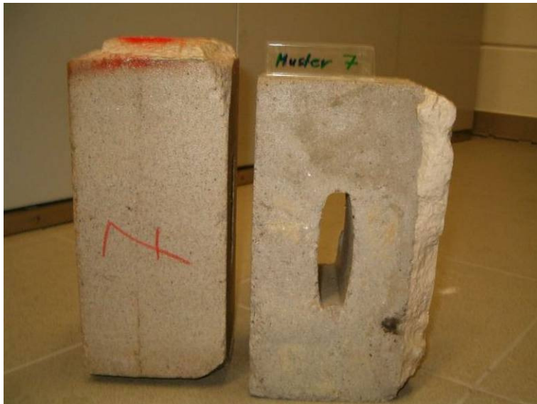
Bild 1: Originalsteine vor Wasserlagerung
