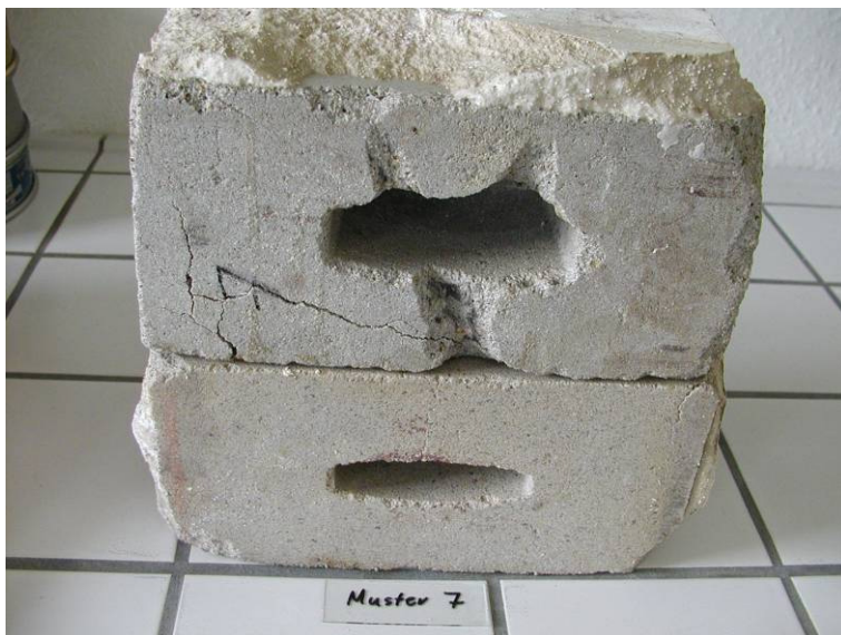
Bild 2: Originalsteine nach 22 Monaten Wasserlagerung bei 5 bis 10 Grad Celsius
